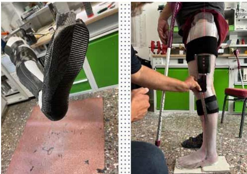
Fertigung der definitiven KAFO (links) und Anprobe der Testschale (rechts)
