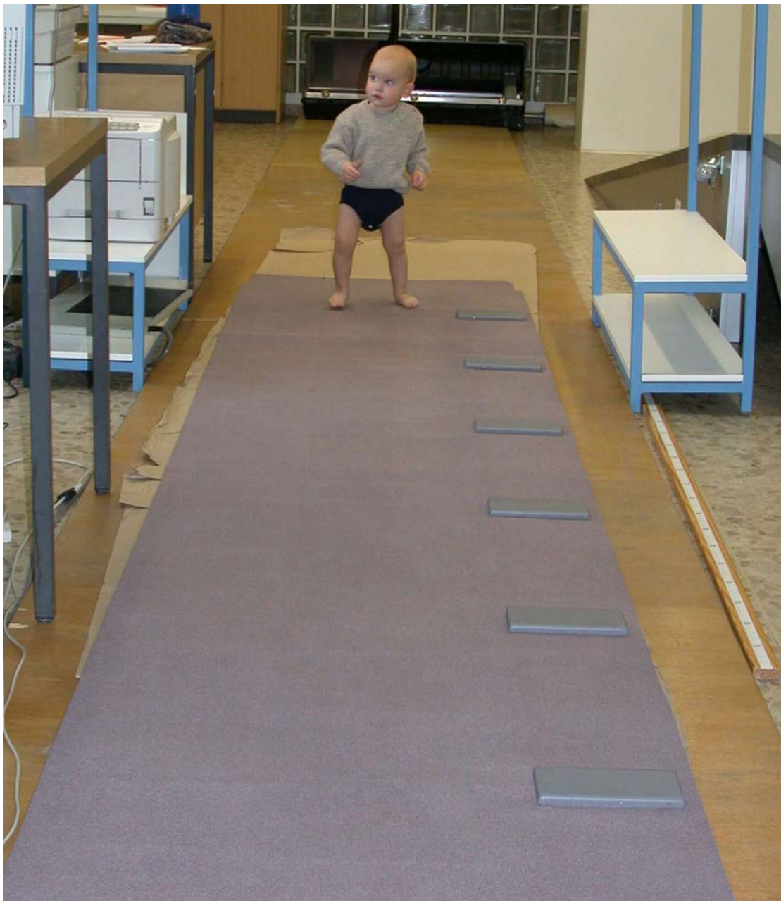
Abbildung 5: Bild des GAITRite-Systems während einer Messung in der Klinischen Prüfstelle für orthopädische Hilfsmittel der Westf. Wilhelms-Universität Münster
