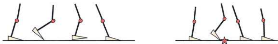
Abb. 1 Bodenfreiheit während der Schwungphase aufgrund Knöchelgelenksbewegung im Vergleich zum festeingestellten Knöchelgelenkfuß
