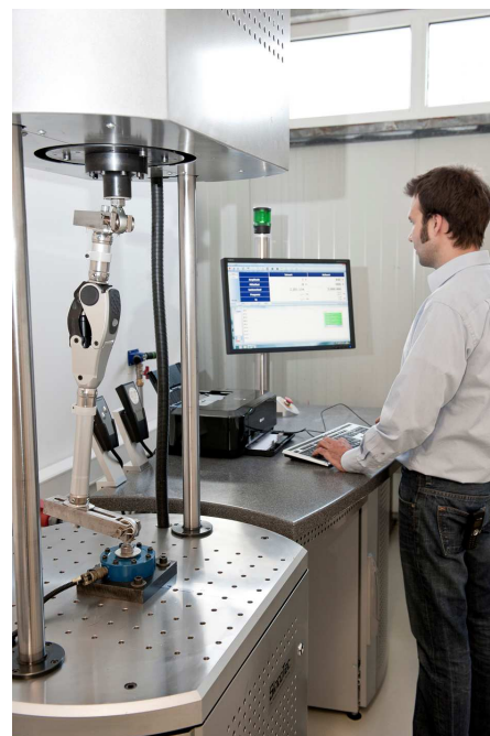
Prüfstand für den Test eines Kniegelenks
